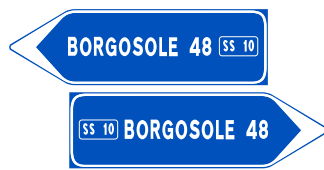
Fig. 249 - 2490 (fondo blu) 2491 (fondo verde) 2492 (fondo bianco) 2493 (fondo marrone) segnale di direzione extraurbano
