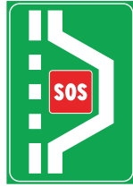
Fig. 329 - 3290 piazzola + sos autostradale
