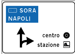
Fig. 233 segnale di preavviso di intersezione urbana
