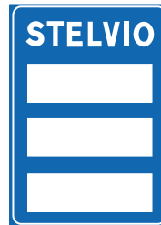
Fig. 330 transitabilità presegnala lo stato temporaneo della transitabilità invernale su strade di montagna, raccomanda pneumatici da neve o catene o li rende obbligatori. la fig. 330 può assumere diverse configurazioni di segnalazione, pertanto le appendici integrative dovranno essere applicate a seconda delle necessità
