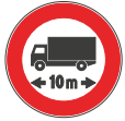
Fig. 67 - 0670 transito vietato ai veicoli complessi di veicoli aventi lunghezza superiore a ... m
