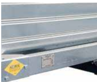
particolare cassone alloggiamento per batterie
