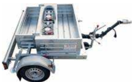
particolare cassone alloggiamento per batterie
