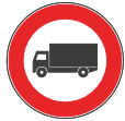
Fig. 60/a - 0601 transito vietato ai veicoli di massa a pieno carico sup. 3,5 ton
