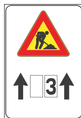
Fig. 4590 segnale fisso di preavviso ad inizio tratta
